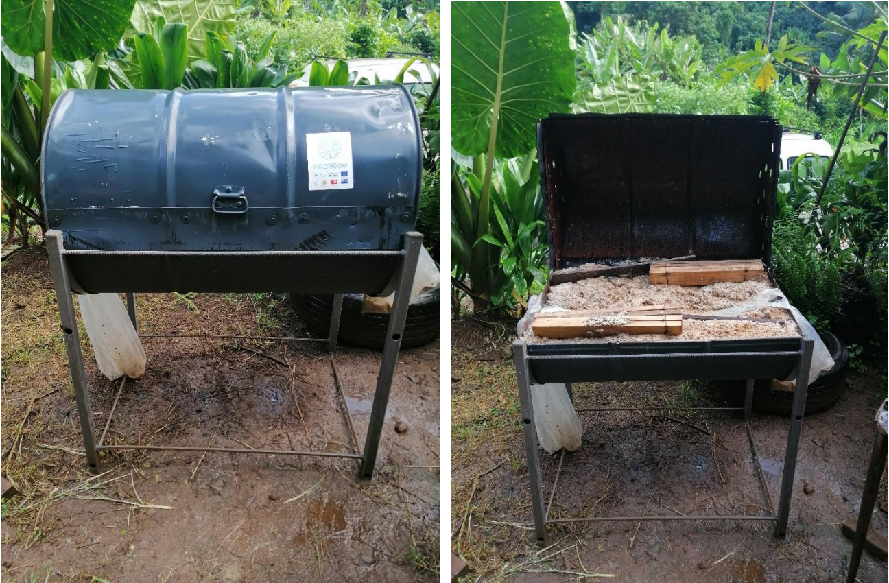
Figure 2 : Photos d'un des prototypes de kit installé dans l'exploitation d'un aviculteur, rempli de résidu de coco râpé pressé
