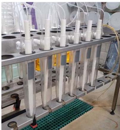
**Figure 7. Unité à haute densité, de type CUDL, destinée à l'élevage larvaire d'huître de roche.**
